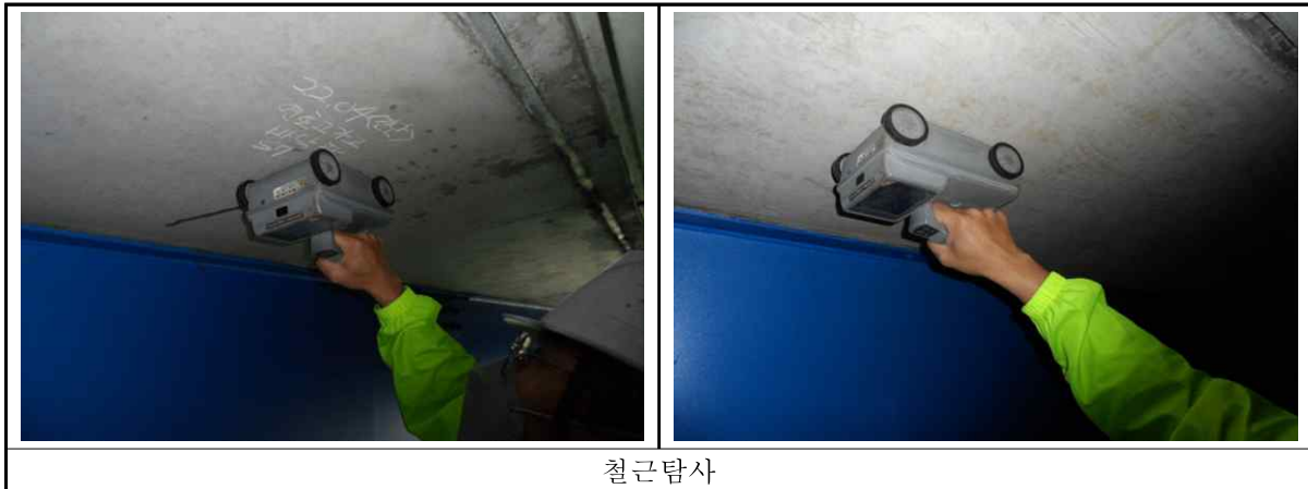
<그림 3.13> 철근탐사 시험
