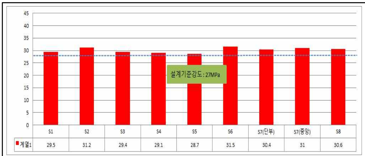
<그림 3.8> 콘크리트 강도조사 결과 (상부구조(안심방향))
