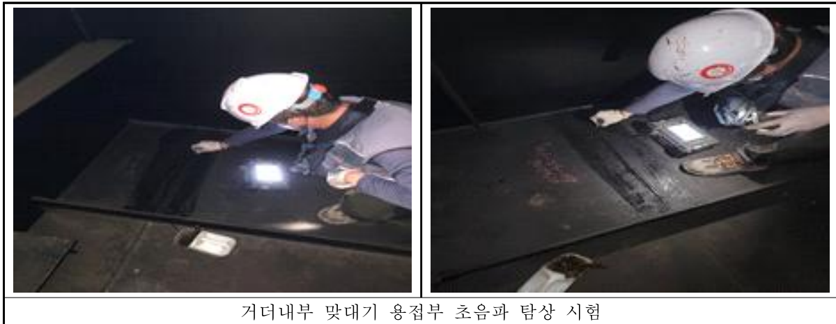
&lt;그림 3.18&gt; 초음파 탐상(사각법) 시험
