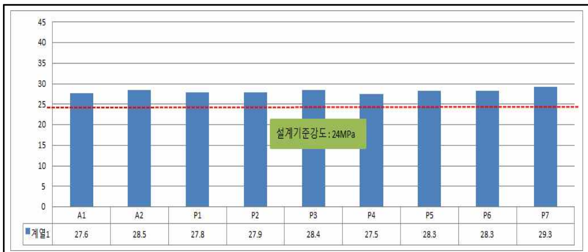
<그림 3.9> 콘크리트 강도조사 결과 (하부구조)
